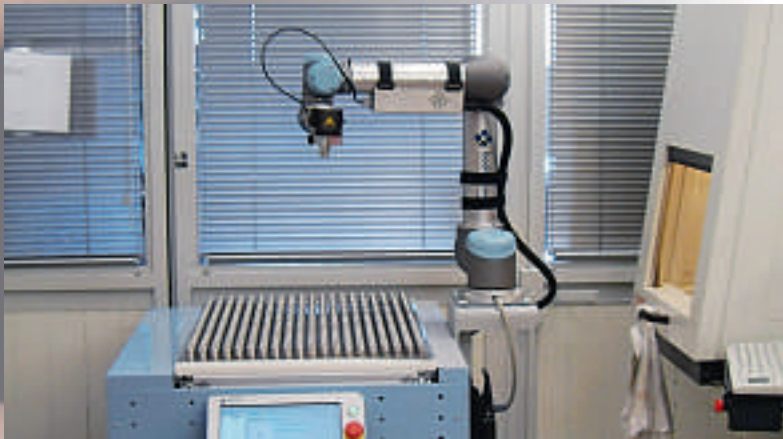
Der zweite Streich: Ein Bachmann «Feed Master» – ebenfalls mit einem UR-Roboter bestückt – im Einsatz bei einer Laserbeschriftungszelle.
