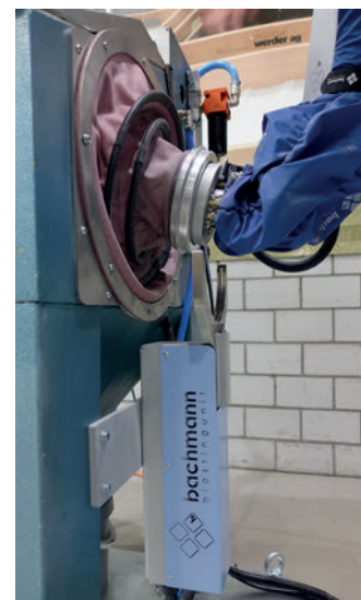
Die Übergabestation, die den Balg und das Koppelungssystem positionsgenau fixiert (Option Bachmann BlastingUnit).
