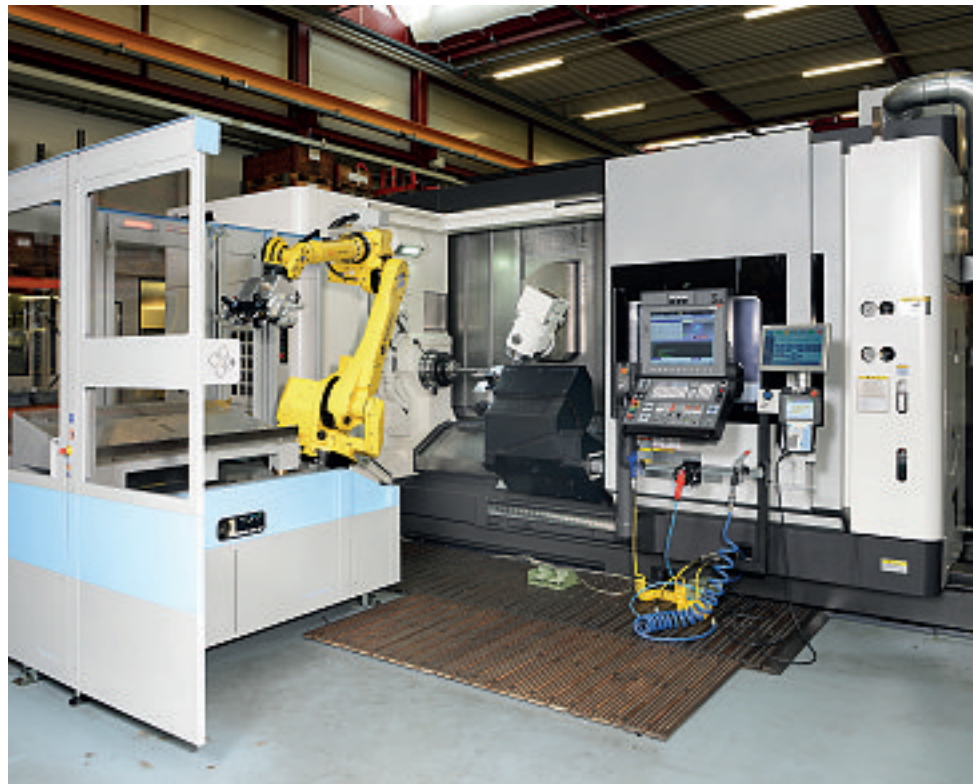
Der Bachmann EasyFeeder bietet auf wenig Aufstellfläche eine satte Autonomie und ermöglicht trotzdem den nahezu uneingeschränkten Zugang zum Bearbeitungszentrum. (Bild: Bachmann)
