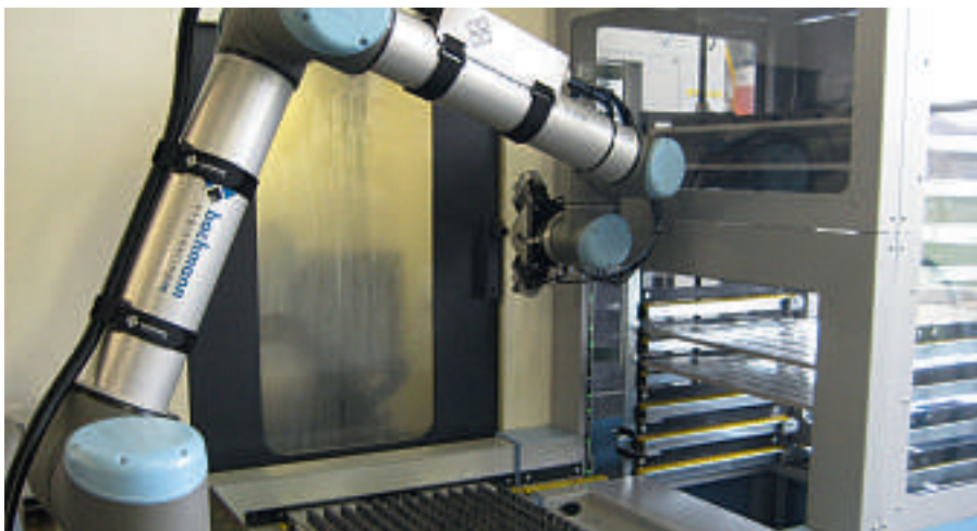
Der Leichtbauroboter des Beschickungssystems BFM öffnet die Türe des CNC-Centers, bevor er ein Werkstück zuführt.
