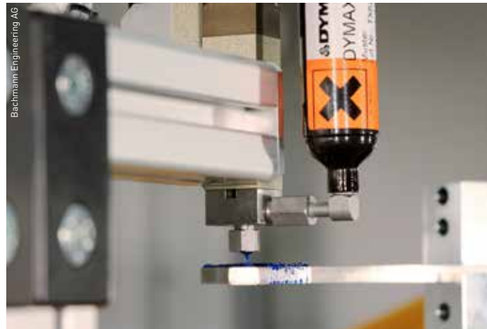
Die bei der automatischen Maskierung zum Einsatz kommenden Polymere sind in unterschiedlichen Viskositäten und mit verschiedenen Eigenschaften verfügbar.
