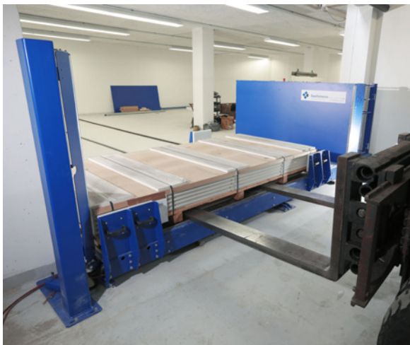
Das halbautomatische Zuführwagensystem kann dem Roboter mehrere Palettenstapel zuführen.
