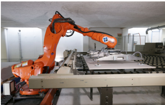
Der Roboter legt eine Platte in das Zuführsystem der Säge ein. (Bilder: Bachmann Engineering)
