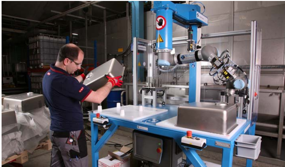
Die Kollaboration mit Leichtbaurobotern ermöglicht auch KMUs, noch effizienter dem Kostendruck zu begegnen. Im Bild: bei der Waschbeckenherstellung. (Bild: Bachmann)
