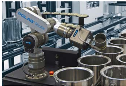
Im Betriebslabor des Baustoffproduzenten Holcim AG in D-Lägerdorf füllen Schunk Leichtbauarme LWA 3.6 Materialproben in entsprechende Behälter. So sinkt die Durchlaufzeit der Proben und die Stabilität des Laborprozesses steigt. (Bild: Schunk)
