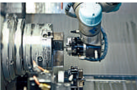
Der Roboterarm entnimmt ein bearbeitetes Werkstück
