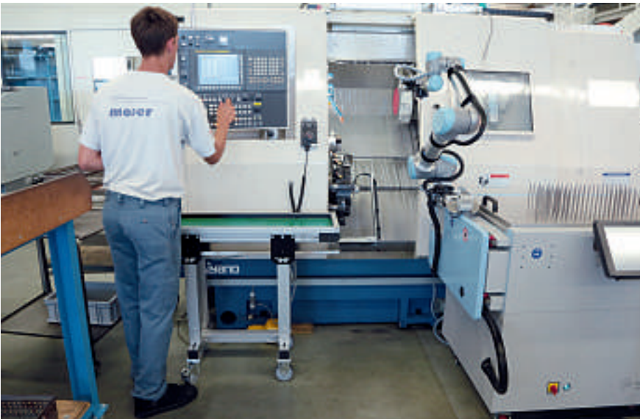
Ein Schutzzaun ist überflüssig; der FeedMaster erlaubt eine enge Zusammenarbeit zwischen Mensch und Maschine
