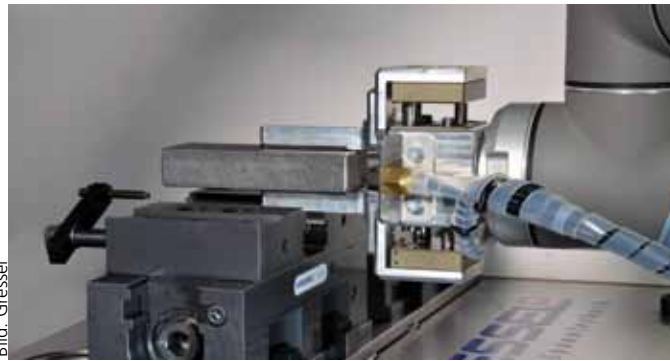
Einlegen des Rohteiles in den hydraulisch betätigten Einfachspanner «Solinos 100H».
