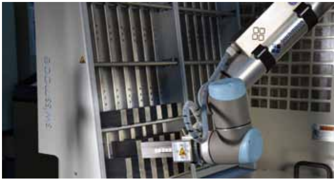
In diesem Bild ist das Rohteilemagazin mit dem Robotergreifer zu sehen.
