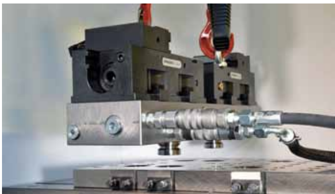
Schnellwechsel-Spanntechnik mit dem mechanischen Nullpunkt-Spannsystem gredec.
