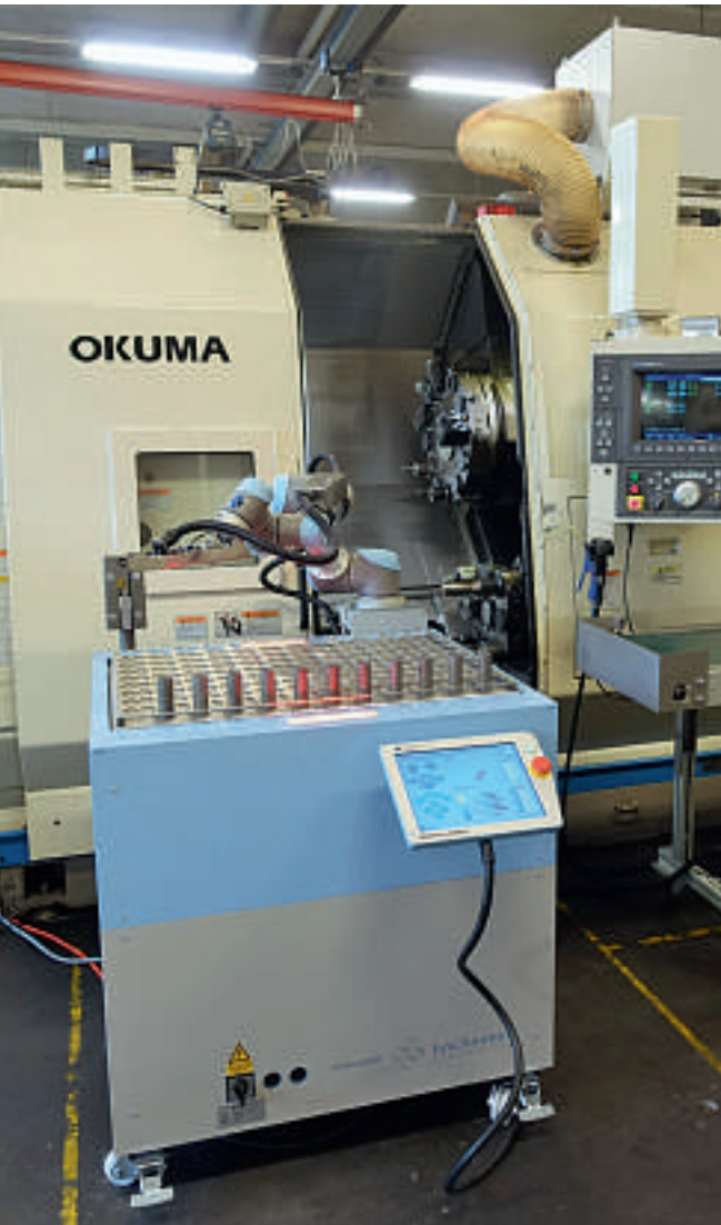
Flexible Automatisierung: Die BFM-Anlage kann innert kürzester Zeit für den Einsatz an einer anderen Fertigungsmaschine umgerüstet werden.
