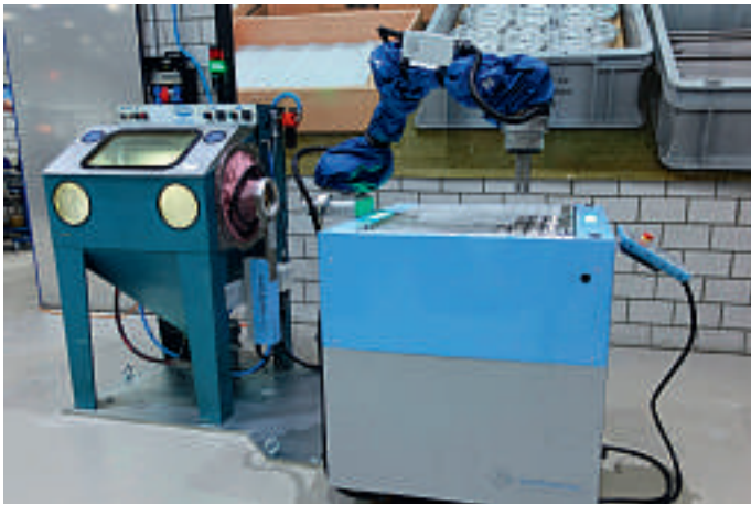
Die Automatisierungslösung «Bachmann BlastingUnit» ist auf Sandstrahlmaschinen zugeschnitten, kann aber auch für andere Anwendungen genutzt werden. (Bilder: Bachmann Engineering)
