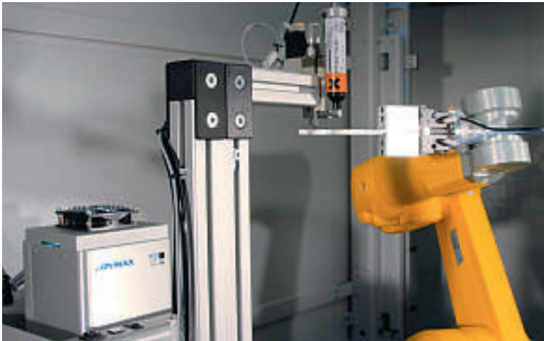
Die werkstückgeführte Maskierung kommt bevorzugt bei kleineren Bauteilen zur Anwendung; Dosiereinheit und Peripherie bleiben statisch.
